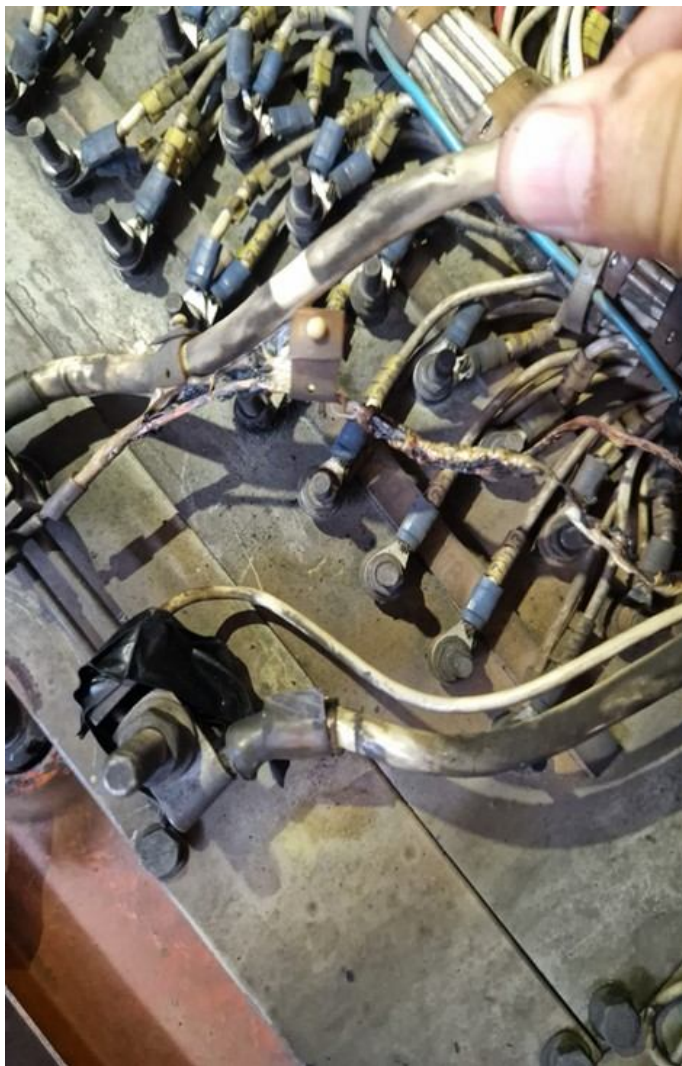
Фиг. 4.15. Обгорял проводник 873
