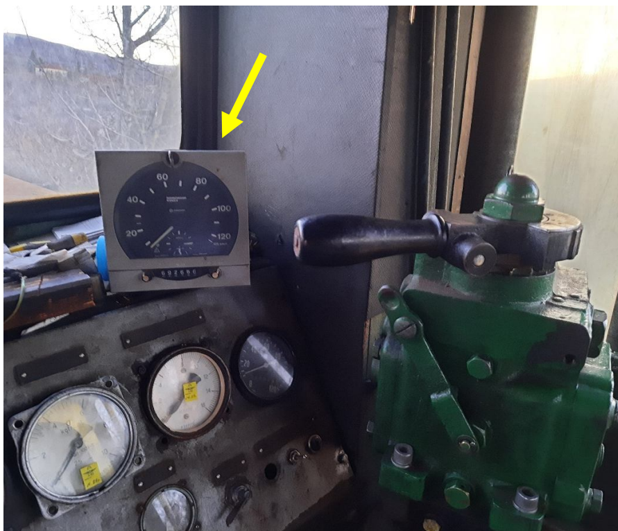
Фиг. 4.1. Аналогов тахограф, монтиран на РСМ № 99529459017-0
