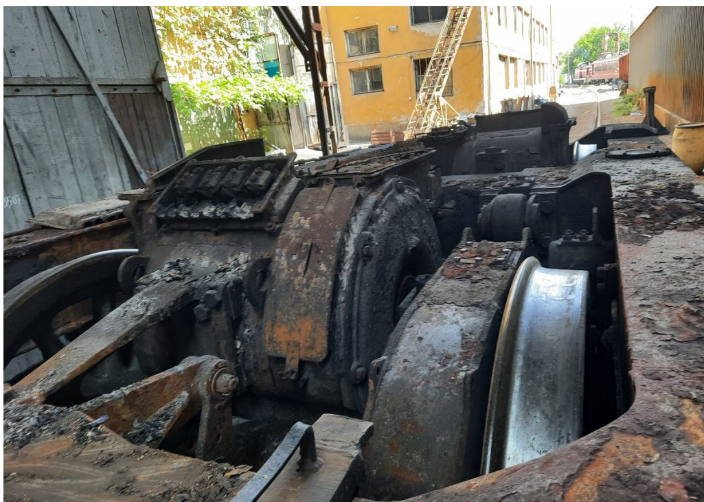
Фиг. 4.14. Състояние на талига и тягов двигател след опожаряването
