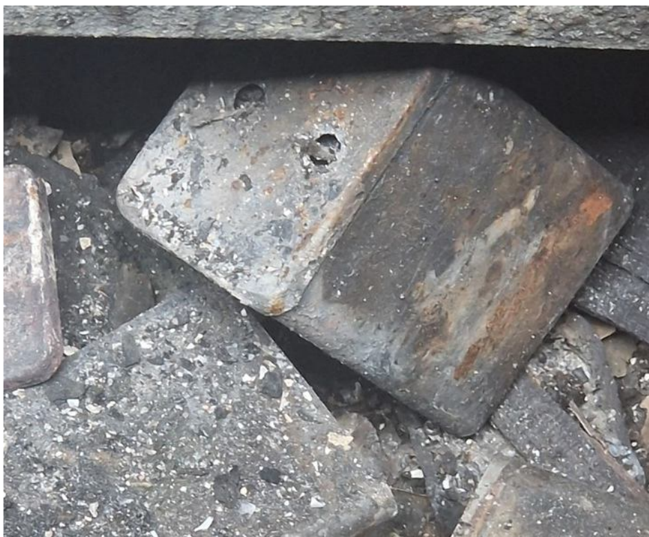
Фиг. 4.8. Изглед на взривен кондензатор от R-C групите на 221
