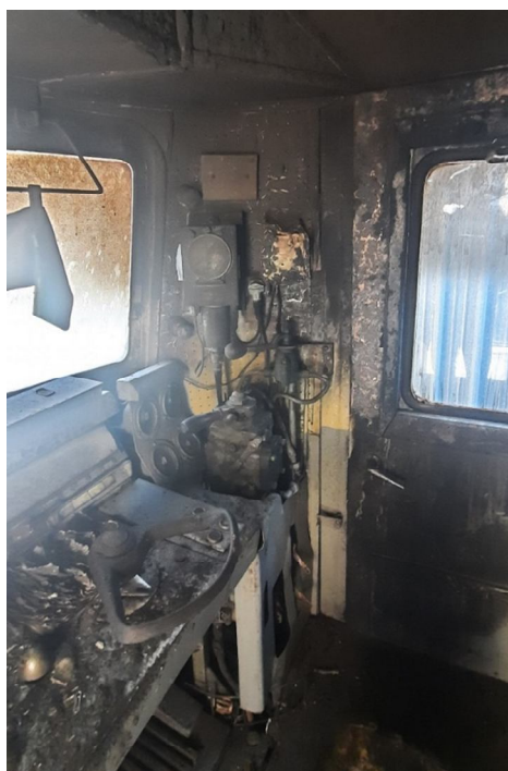
Фиг. 4.11. Състояние на командна кабина № 1 след опожаряването
