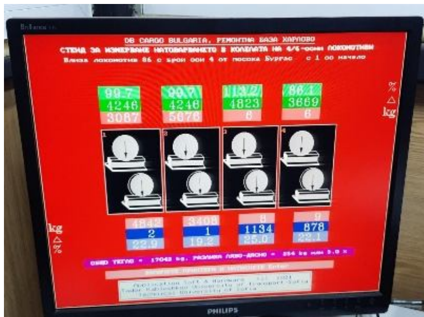
Фиг. 2.7. Резултати от измерването на статичното натоварване на колелата на № 21802475039-8 в РЦБО Карлово на 09.05.2024 г.
