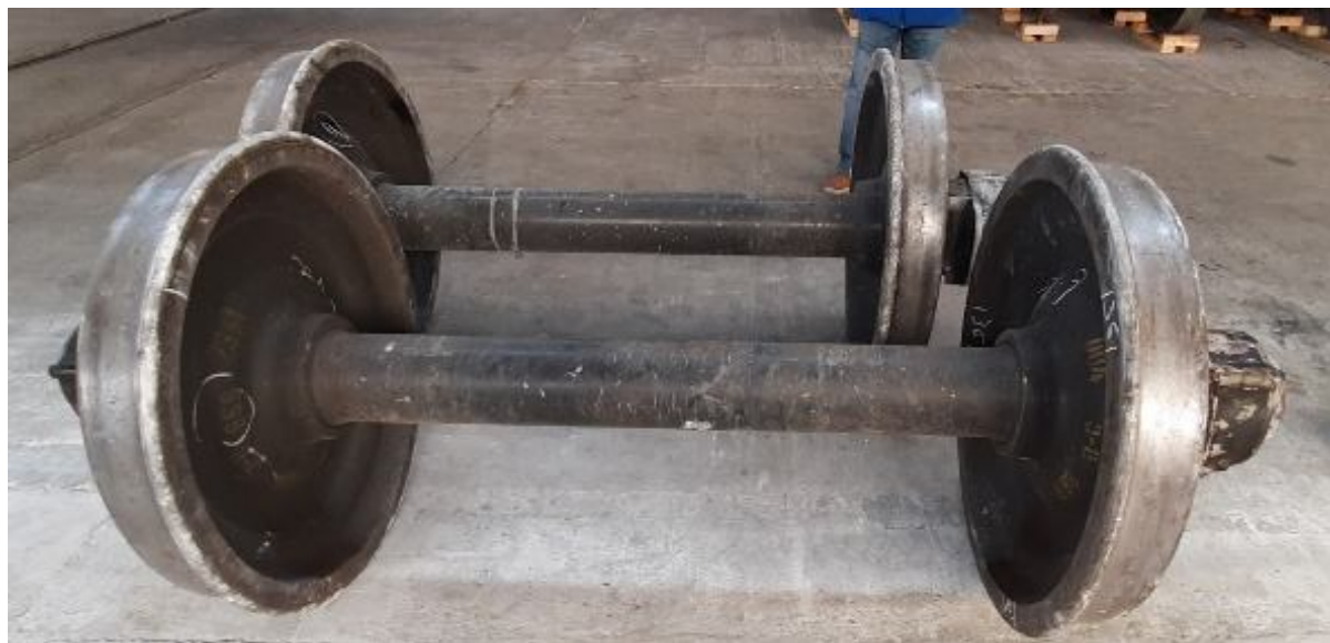
Фиг. 2.3. Колоосите на дерайлирания вагон № 21802475039-8
