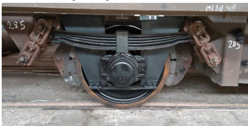
Фиг. 2.6. Ремонтираната ходова част на вагон № 21802475039-8 в РЦБО Карлово
