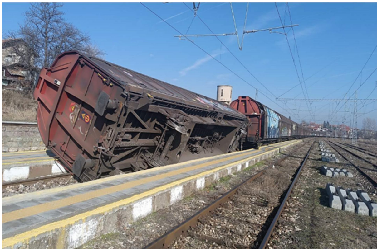
Фиг. 2.1. Дерайлиралите последни два вагона от МДТВ № 46660
