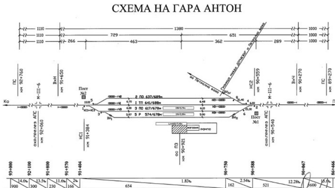
Фиг. 3.7. Схема на коловозното развитие на гара Антон
