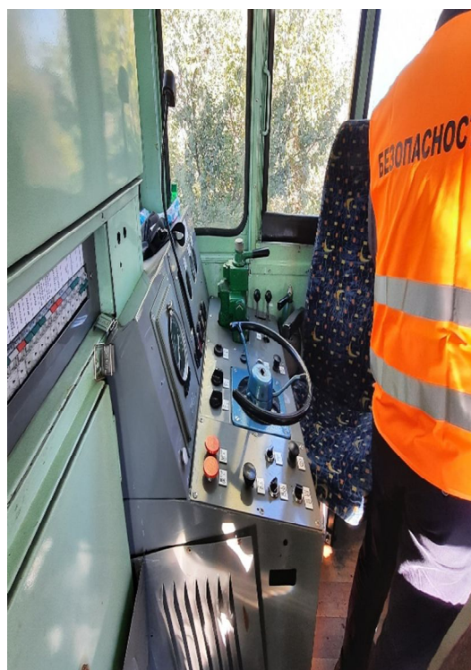
Фиг. 4.4. Разположение на уредите и апаратите на пулт № 2 на локомотив № 98522051522-7.
