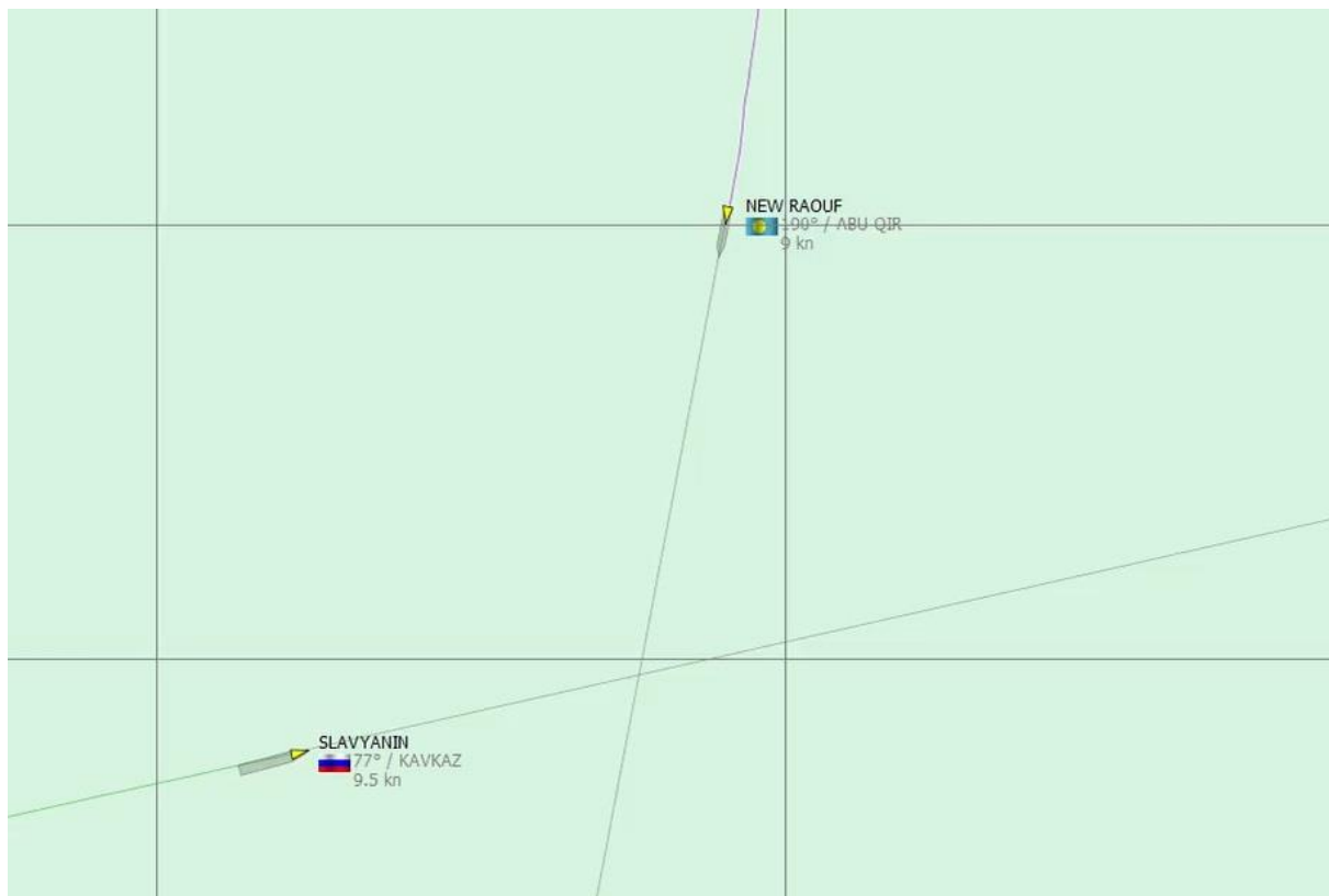
Фиг. 3 – Изображение, показващо взаимното разположение на двата кораба преди сблъскването, получено от VTS – Варна.
