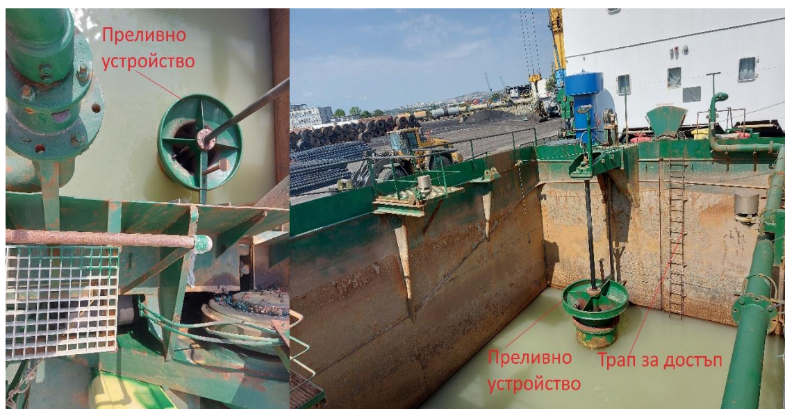
Фиг. 4 – Преливно устройство и трап за достъп до товарното помещение на драгажен кораб „MILFORD“ .
